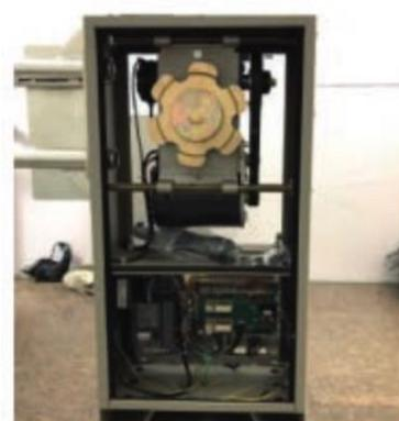
Unidade Ultra-Quiet está localizada em uma caixa trancada no pavimento superior da plataforma e usa um sólido inversor acoplado ao motor elétrico de 2hp de potência. A configuração programável do controlador de Programa (PCC) permite que a Artira seja personalizada para cada instalação em escadas, incluindo desaceleração nas curvas e patamares.
